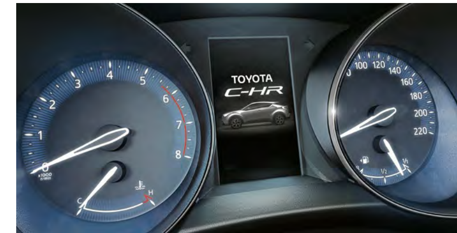
4,2-дюймовый цветной TFT-дисплей на панели приборов
