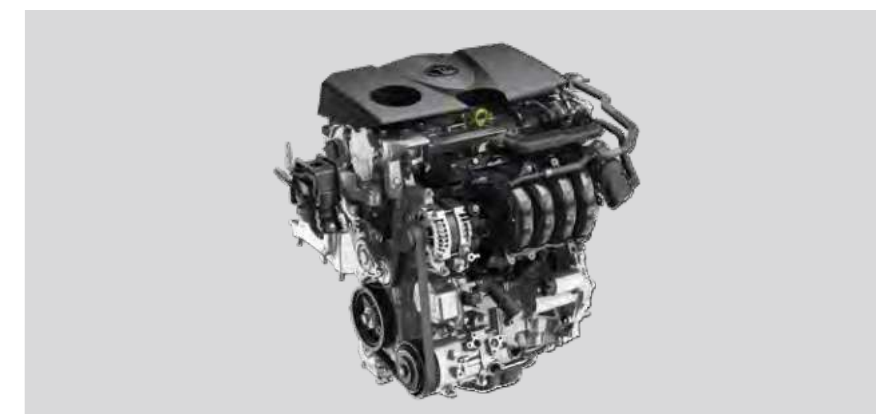
Два новых двигателя TNGA 2 и 2,5 л серии Dynamic Force.
